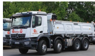
8x4 Bi-benne Charge utile : 17 T Dimensions : 580 x 230 Equipement(s) : bache cramaro
