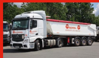
Semi-benne Alu - 3 essieux Charge utile : 32 T Dimensions : 720 x 250 Equipement(s) : bache cramaro
