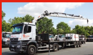
Semi-remorque grue Charge utile : 30 T Dimensions : 1250x250 Equipement(s) : ranchers
