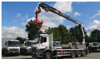
G15 8x4 Charge utile : 15 T Dimensions : 750x250 Equipement(s) : grue avant ou arrière retourneur de plaque / ranchers
