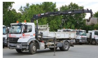
4x2 Grue bi-benne Charge utile : 7 T Dimensions : 520 x 230 Equipement(s) : bache cramaro Godet / Fourche
