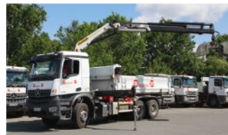
6x4 Grue bi-benne Charge utile : 10 T Dimensions : 520 x 230 Equipement(s) : bache cramaro godet / fourche
