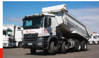
8x4 Enrochement Charge utile : 17 T Dimensions : 600 x 230 Equipement(s) : bache cramaro
