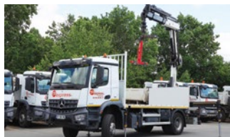
G7 4x2 Charge utile : 7 T Dimensions : 500x250 Equipement(s) : grue arrière
