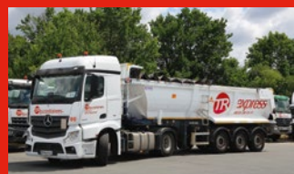
Semi-benne Enrochement - 3 essieux Charge utile : 27.5 T Dimensions : 720 x 250 Equipement(s) : bache cramaro
