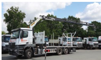
G10 6x2 Charge utile : 10 T Dimensions : 610x250 Equipement(s) : grue avant ou arrière dossard / ranchers
