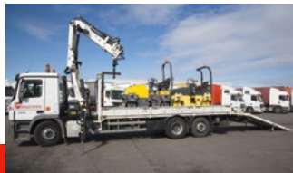
GR Camion rampe 6x2 Charge utile : 10 T Dimensions : 770x250
