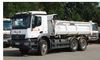
6x4 Bi-benne Charge utile : 13 T Dimensions : 520 x 230 Equipement(s) : bache cramaro
