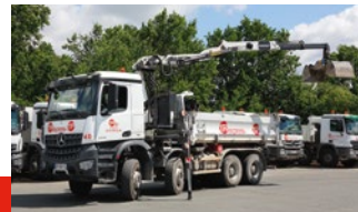
8x4 Grue bi-benne Charge utile : 17 T Dimensions : 520 x 230 Equipement(s) : bache cramaro
