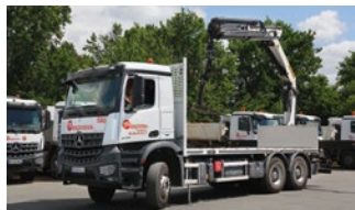
G13 6x4 Charge utile : 13 T Dimensions : 610x250 Equipement(s) : grue avant ou arrière dossard / ranchers retourneur de plaque
